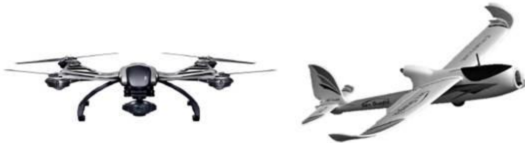
Figura 1. Drones utilizados en la agricultura: (a) multirrotor (cuadricóptero), (b) de ala fija. Consultado: (Patel, 2016).
